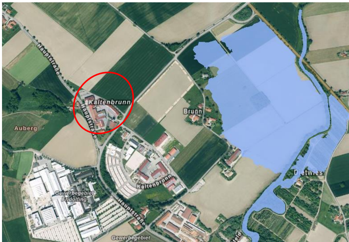
Abb. 14 Hochwassergefahrenflächen HQ100 der Götzinger Acher (Ermittlungsdatum 15.12.2015) mit Kennzeichnung des Planungsgebiets (rot umrandet) – Ohne Maßstab
