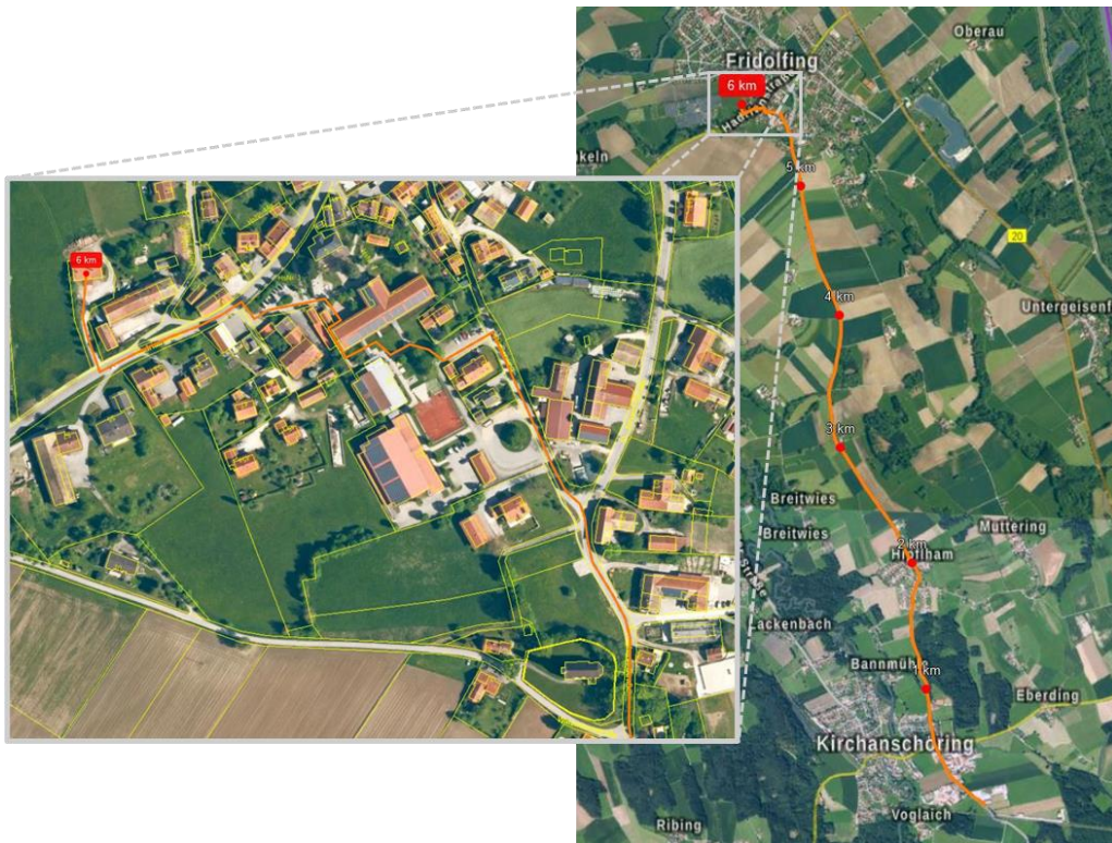
Abbildung 10: Potenzieller Trassenverlauf einer Fernleitung zur Einbindung geothermaler Wärme aus Kirchschoring in die EZF (Quelle: geoservices.bayern.de, Bayerische Vermessungsverwaltung, EuroGeographics; Bearbeitung IfE)
